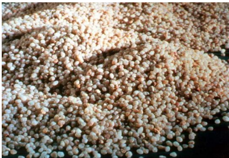
图 过滤介质：石英砂
